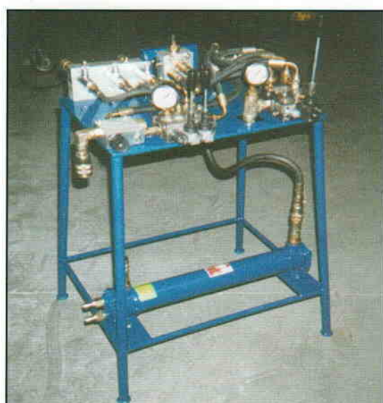
Qui sopra è illustrato lo stesso dispositivo munito di uno scambiatore di calore per il raffreddamento dell'olio.
