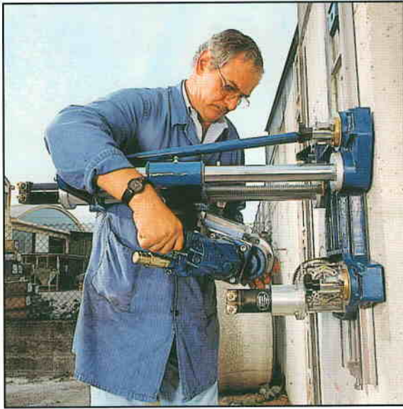
Scomposizione in due parti delle taglia-muri: consente il montaggio con un solo operatore per mezzo di un giunto rapido a coda di rondine conico.
