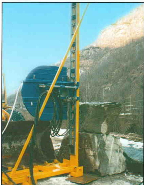
Montaggio della TG 1200 S su una pala gommata; esegue tagli con spostamenti rapidi.
