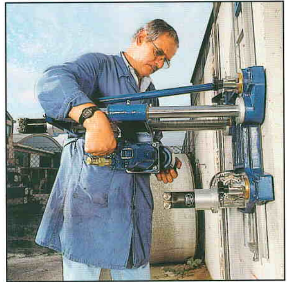
Scomposizione in due parti delle taglia-muri: consente il montaggio con un solo operatore per mezzo di un giunto rapido a coda di rondine conico.
