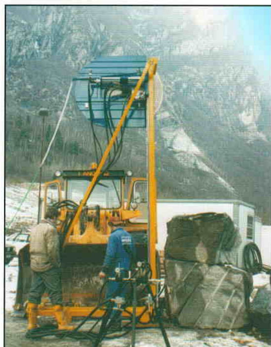
Montaggio della TG 1200 S su una pala gommata; esegue tagli con spostamenti rapidi.
