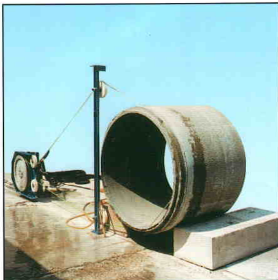
Taglio con filo diamantato applicabile sulla TG 1200 S
